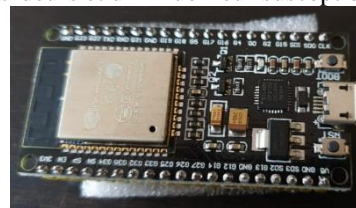
Figure 47 : module NodeESP32 acquis pour commencer les développements (GIMEole2021)
