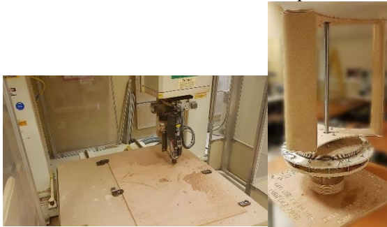
Figure 34 : à droite, une Dionysienne à axe vertical de 2018 réalisée avec de nombreuses pièces en bois usinées avec la MOCN "Thermwood 67"
