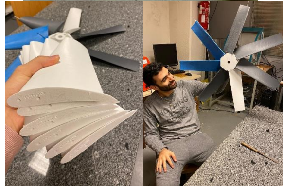
Figure 31 : jeux de pales de différents profils, expérimentés puis rangés. A droite, montage d'une turbine 7 pales (Dionysienne à axe horizontal 2020)
