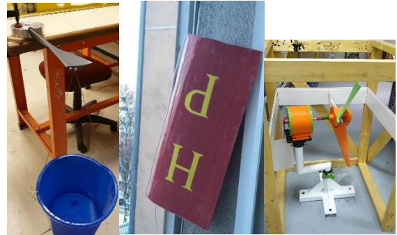
Figure 54 : test de rigidité d'une pale montée sur son support de pales. Au centre, test de résistance aux intempéries d'une demi pale en la laissant tout un hiver accrochée à la fenêtre de l'IUT. A droite, vérification rapide des dimensions de l'éolienne une fois montée à l'aide d'un cadre en bois construit selon les préconisations du règlement (Dionysienne à axe horizontal 2019).
