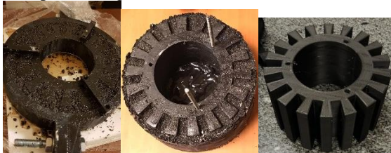
Figure 41 : démoulage du stator en résine et limaille de fer (Dionysienne à axe horizontal 2020). Moules extérieurs et intérieurs (ici à droite) imprimés 3D.
