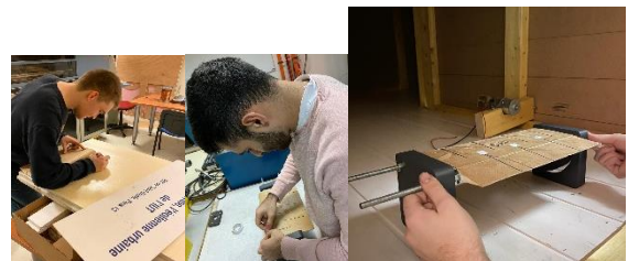
Figure 55 : mesure de l'angle de décrochage aérodynamique des pales de la Dionysienne à axe vertical par observation en soufflerie d'un petit fil fixé au profil.
