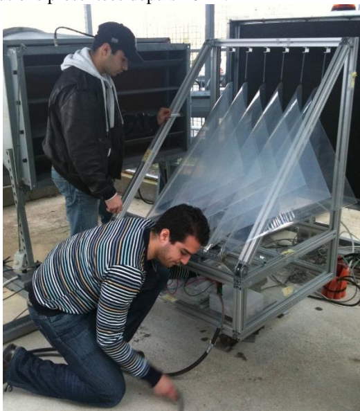
Figure 1 : Dionysienne "ondulienne" (2011, Cherbourg, Prix de l'innovation). Les voiles, soumises au vent, entraînent dans un mouvement de translation un chariot sur lequel est assemblée une génératrice linéaire. Principe validé par une production très faible obtenue l'année suivante et avec une seule voile.
