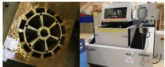
Figure 36 : prototype de rotor en acier massif en cours de découpe avec un procédé d'électroérosion. On observe les logements des 12 aimants permanents à la périphérie du futur cylindre. A droite, le procédé de découpe par électroérosion (MOCN Mitsubishi Electric, Advance type 2) mis en œuvre par un technicien des PT.
