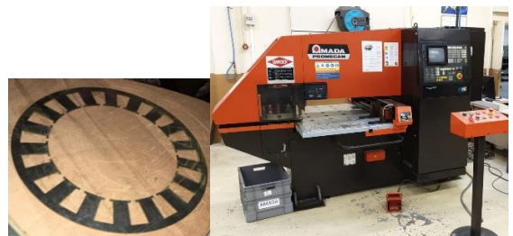
Figure 37 : tôle statorique découpée à la poinçonneuse-grignoteuse puis recouverte d'un vernis isolant au pinceau. A droite, procédé de grignotage de tôles (MOCN Amada Promecam Aries 222) mis en œuvre par un technicien des PT.
