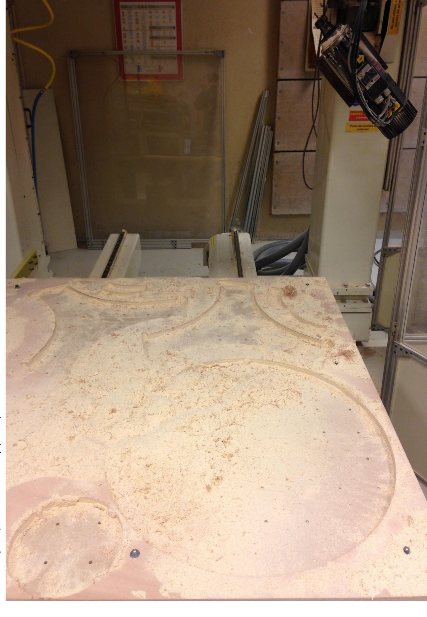
Usinage des constituants bois par MOCN 3 axes
