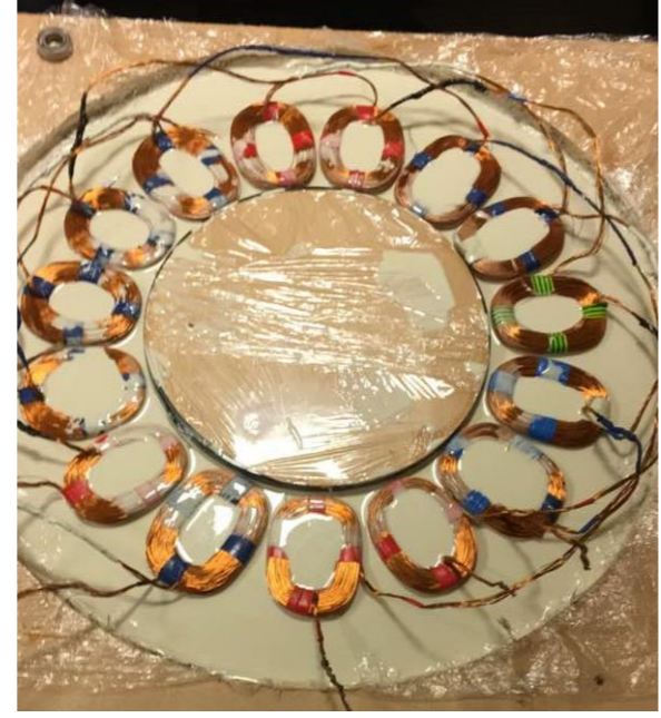
Plateau des bobines (coulées dans la résine)
